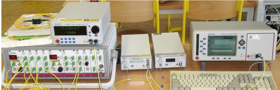
Organizace pracoviště pro měření na EDFA zesilovači (vlevo) a SOA zesilovači (uprostřed). Spektrální analyzátor je vpravo
